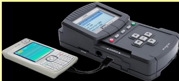
Esempio di acquisizione con Cellebrite UFED
